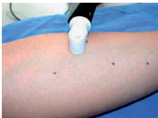
Figura 2. — Tewameter™: sonda che si appoggia sulla zona da misurare. Figure 2. —Tewameter™ probe applied to the skin.
